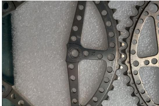
中学生の頃の軽量加工1号。ハンドドリルで空けた物とボール盤を使用した物で現在も人力ボートで使用
