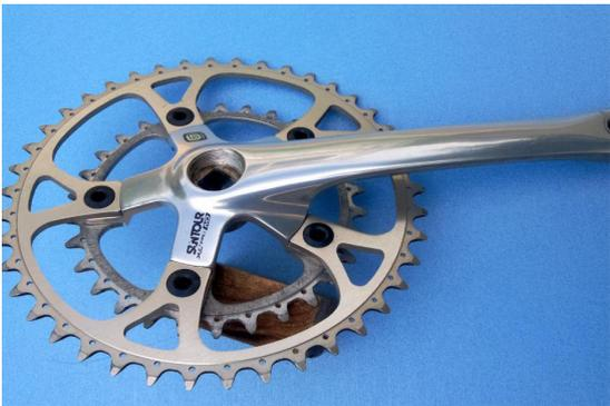
M TB時代のトリブルクランクは小さすぎるインナー取付部分を削り落とし、ボリュームのある全体を細身に仕上げる。高品質であるがQファクターはどうしても広がる
