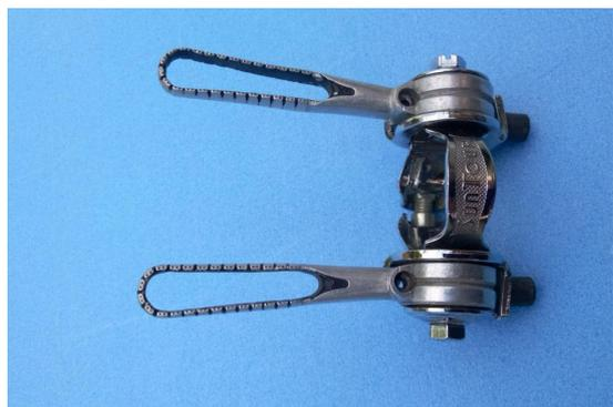
Y田君所有のレリーフ部分が完全に肉抜きされたサンツアーのWレバー。覚えていないが僕が加工してプレゼントしたらしい。強度的に不安なので未使用
