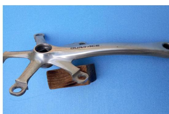
シングルで使用したのはデュラエースで最も細身のクランク。面取りなどで更に軽量化するが強度は十分、この後のモデルは中空クランクになる
