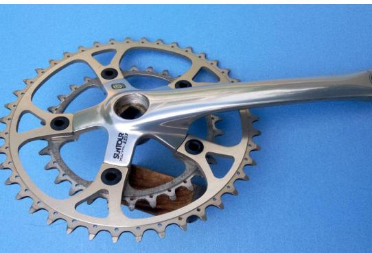
MTB 時代のトリプルクランクは小さすぎるインナー取付部分を削り落とし、ボリュームのある全体を細身に仕上げる。高品質であるが Q ファクターはどうしても広くなる
