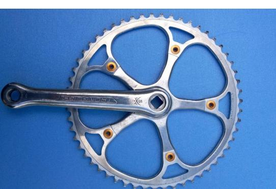
ミニベロに使用したストロングライトの新型クランク。55T リングの 5 アーム先端には気付かないような扇型の肉抜き
